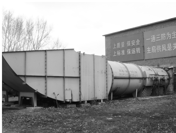
鹤矿集团峻德煤矿抽出式 BDK 节能型对旋轴流主扇
