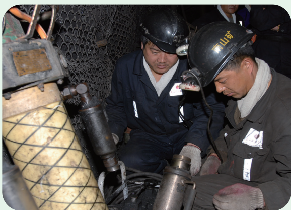
鹤岗矿业集团公司益新煤矿井下工人检查锚索钻具
